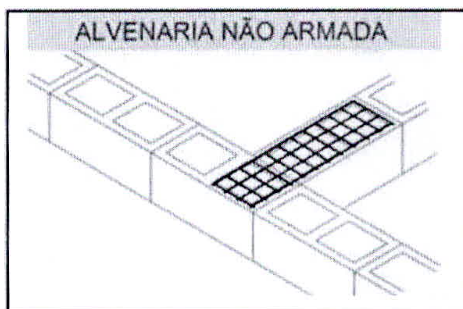
Figura 12 – Alvenaria não armada
