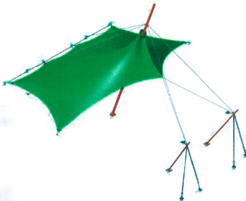
Figura 28: Sistema de cobertura por tirantes
