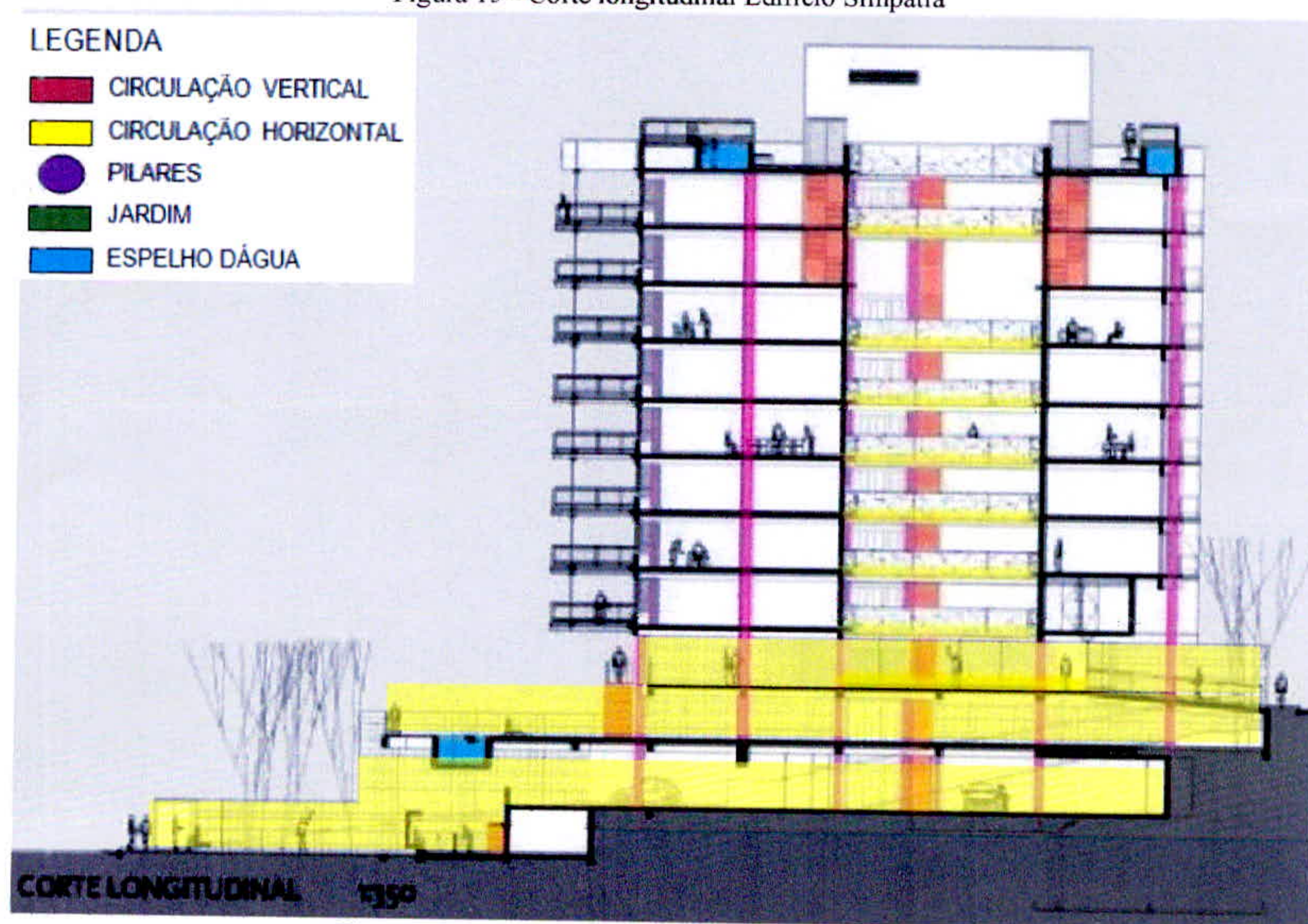
Figura 15 - Corte longitudinal Edifício Simpatia
