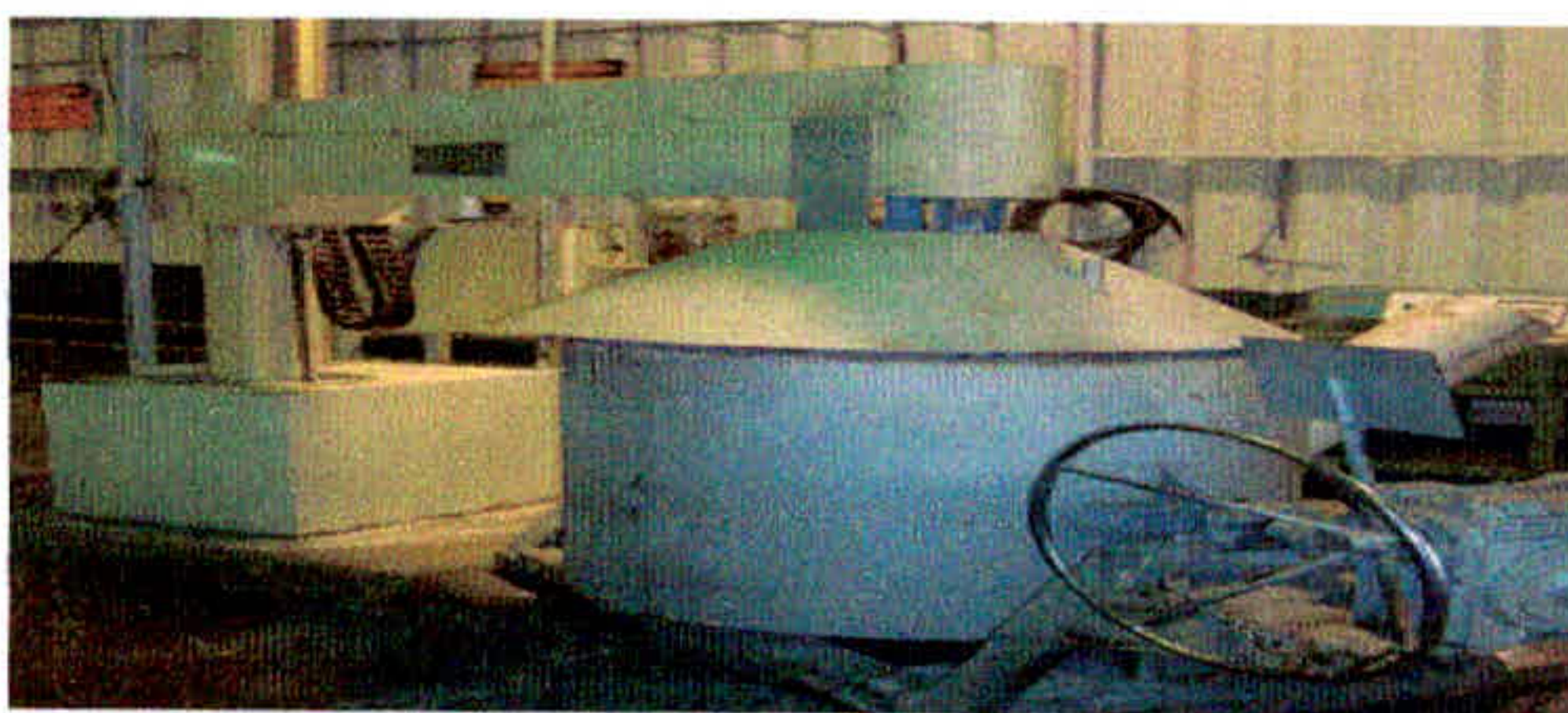
Figura 8: Unidade de desgaseificação e panela com alumínio líquido. Fonte: Autor
