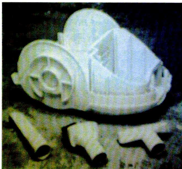
Figura 42: Exemplo de Peças Obtidas do Processo SLS. FONTE: Neri Volpato – Tecnologia e Aplicações Pág. 84
