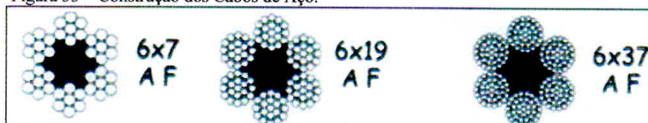
Figura 33 – Construção dos Cabos de Aço.
