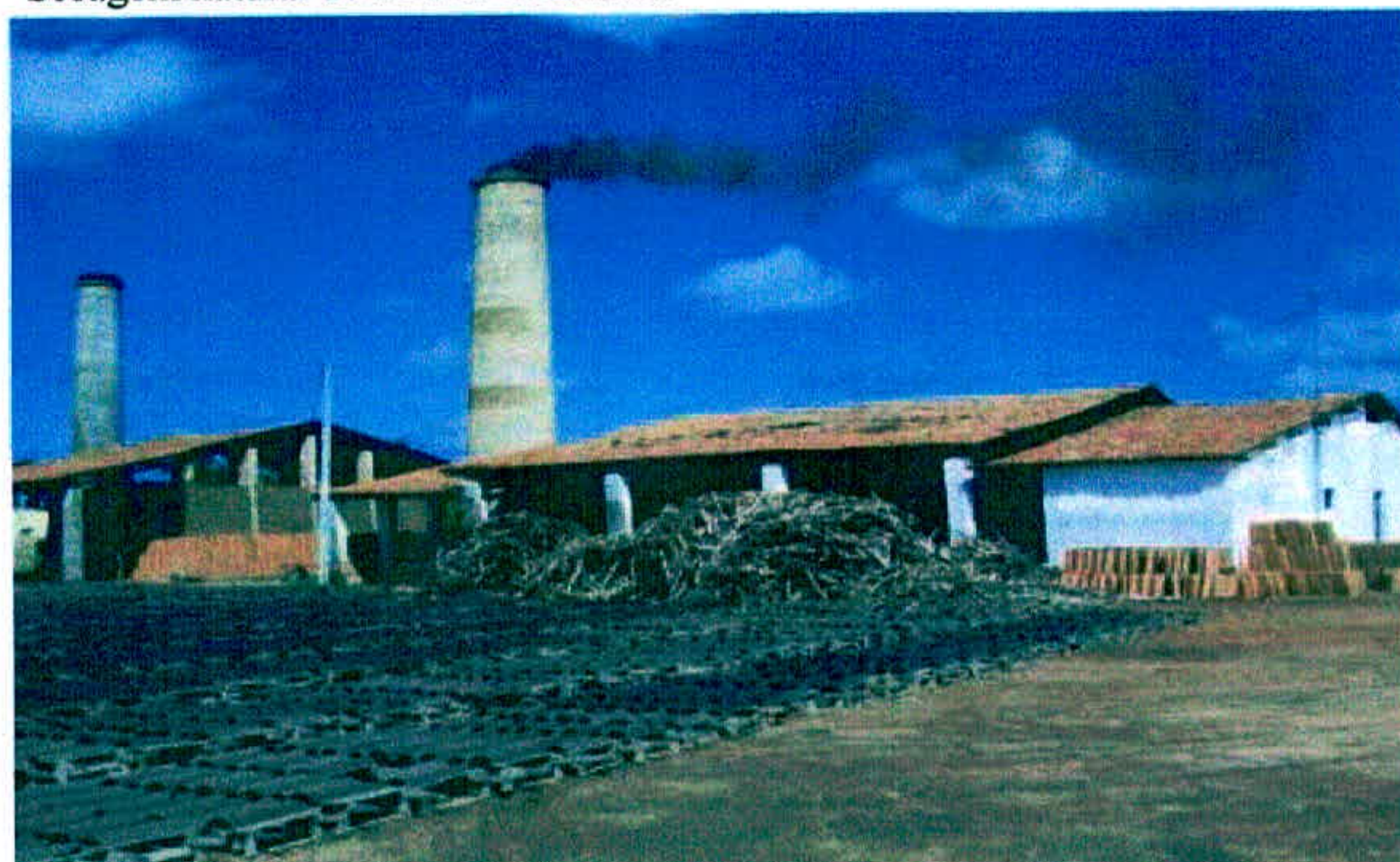
Figura 01 – Secagem natural de blocos cerâmicos
