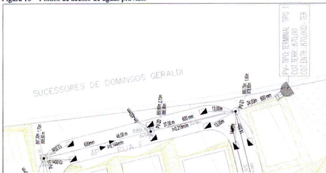
Figura 18 – Pontos de acesso de águas pluviais
